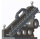
Orientierung des Prüfkörpers im Raum 1 Orientation of the artefact in space 1
