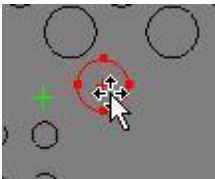
Beispiel: Verschieben einer kreisförmigen Messlehre
