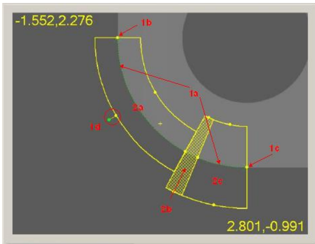
PC-DMIS Vision: Anzeige von Tracker und Zielen in der Live-Ansicht
