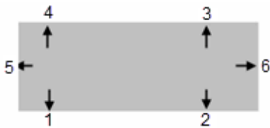
Messung eines Rechtecklochs mit 6 Messpunkten
