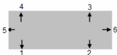
Messung eines Rechtecklochs mit 6 Messpunkten
