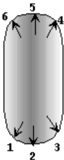
Langloch mit mindestens 6 Messpunkten
