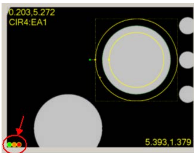
PC-DMIS Vision: Anzeige eines farbigen Licht-Countdowns in der Live-Ansicht
