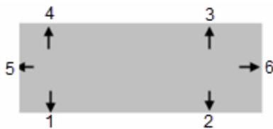
Messung eines Rechtecklochs mit sechs Messpunkten
