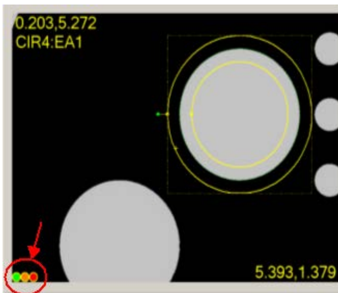
PC-DMIS Vision: Anzeige eines farbigen Licht-Countdowns in der Live-Ansicht
