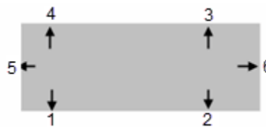
Messung eines Rechtecklochs mit sechs Messpunkten
