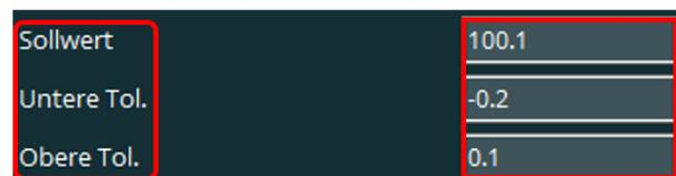
Der hier definierte Werte werden nach Klick auf die Schaltfläche „[Befehl in die Messroutine schreiben](#)“ (siehe unten) für das benutzerdefinierte Element und das Merkmal in der Messroutine verwendet (siehe unten: [Übertragene Daten in der Messroutine](#)).
