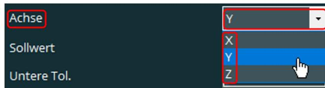
Die gewählte Achse wird nach Klick auf die Schaltfläche „[Befehl in die Messroutine schreiben](#)“ (siehe unten) für das benutzerdefinierte Element und das Merkmal in der Messroutine verwendet (siehe unten: [Übertragene Daten in der Messroutine](#)).
