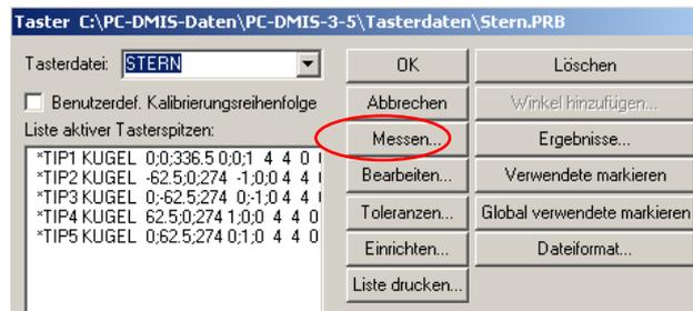
Nach dem Anklicken wird das folgende Fenster geöffnet. Hier können die zur Abarbeitung eines parametrisierten Kalibrierprogramms erforderlichen Eintragungen gemacht werden.
