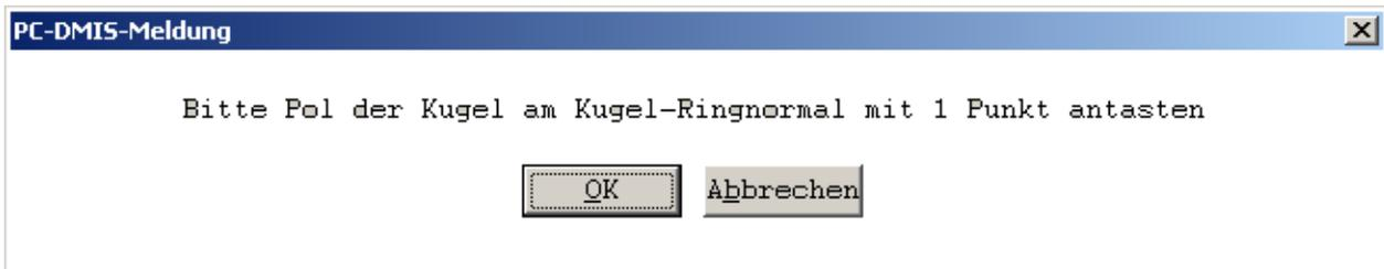
Nachdem der Punkt angetastet wurde und die „END“ Taste am Bedienpult gedrückt oder „Fortfahren“ im „Ausführungsoptionsfenster“ geklickt wurde wird die Kugel automatisch mit 5 Punkten eingemessen.
