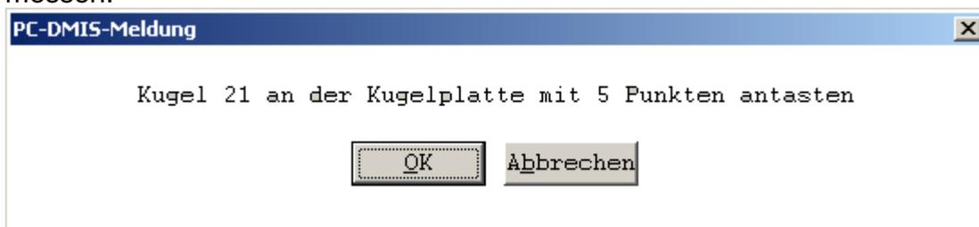
Danach beginnt die CNC Ausrichtung der Kugelplatte, die Messung der 25 Kugeln auf der Kugelplatte, sowie die Wiederholmessung der Kugeln 1,5,21.
